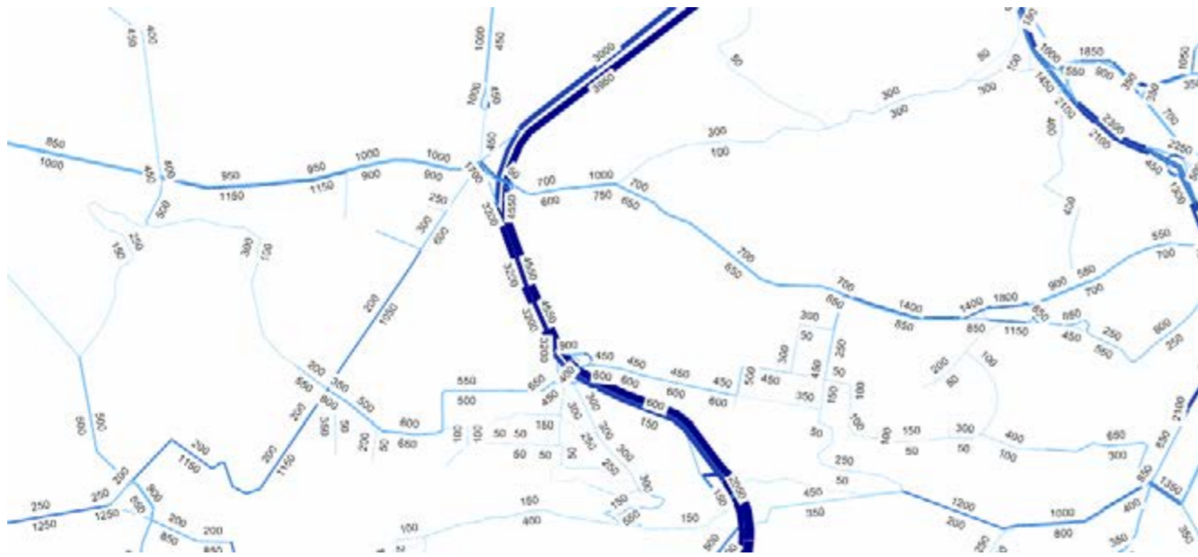
Flux à l'heure de point du matin (HPM) en vvp/h en 2017 (source Tractebel, 2018)
